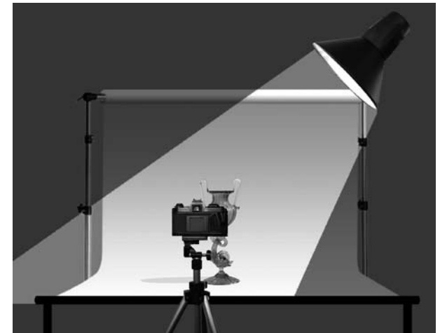
Foto 24. Esquema para objetos translúcidos: fuente de iluminación intensa lateral.
