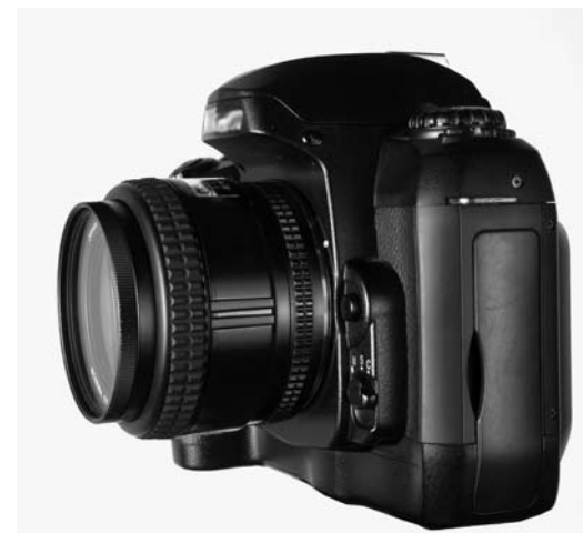
Foto 2. Cámara réflex digitales con objetivos intercambiables. Tienen un sensor de mayor tamaño que las compactas, con lo que se logra mayor calidad de imagen y mayor sensibilidad con un nivel de ruido muy reducido. Su uso es normalmente más complejo que el de las cámaras compactas, pero con más control por parte del usuario.
