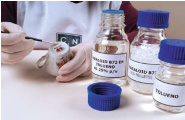
Foto 2. Aplicación de una capa delgada y rectangular de resina acrílica. Su tamaño debe ser proporcional al formato del código (Archivo CNCR, 2008).
