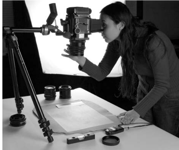
Foto 3. Fijación de la cámara en trípode para tomas en horizontal.
