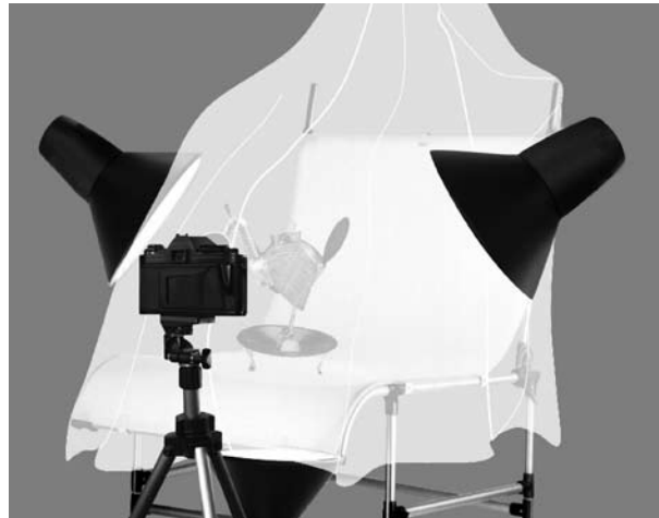
Foto 22. Esquema para objetos volumétricos metálicos: fondo traslúcido de color blanco iluminado en la base, escena cubierta con tela blanca, dos fuentes de iluminación fuera de la cubierta. La cámara se ubica fuera de la cubierta, ingresando solo el objetivo a través de una pequeña perforación.
