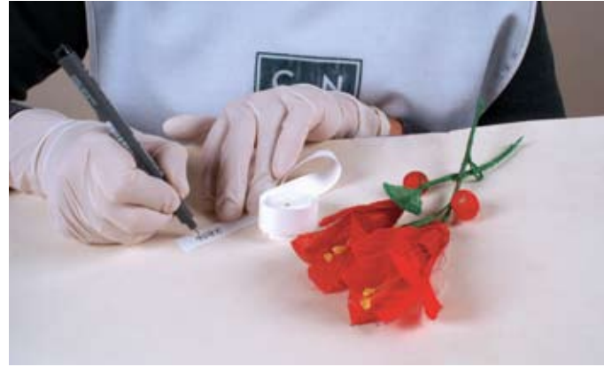
Foto 9. Aplicación del rótulo sobre una etiqueta sellada con resina acrílica, empleando un lápiz técnico de tinta permanente (Archivo CNCR, 2008).
