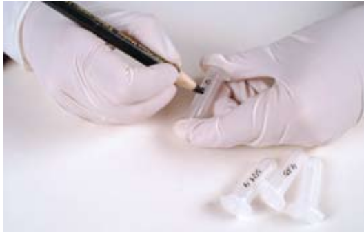
Foto 6. Aplicación directa del rótulo sobre contenedores plásticos, utilizando un lápiz dermatográfico (Archivo CNCR, 2008).
